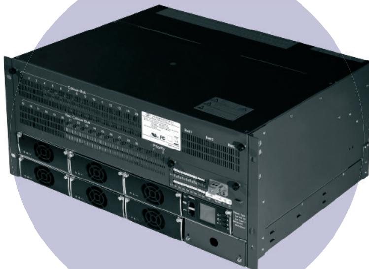
СТ48-3/18кВт – компактная и интеллектуальная система электропитания, в состав которой входит до шести выпрямителей мощностью 3 кВт и один контроллер МК501. Выходы постоянного тока и «сухие» контакты доступны спереди, а подключение к силовым кабелям сзади. Компактный корпус, легкая установка, удобная эксплуатация, три автоматических выключателя батарей, три уровня защиты LVD.
