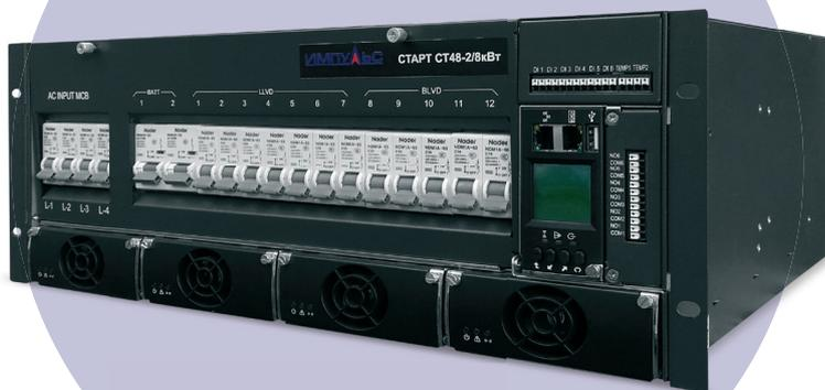
Система СТ48-2/8кВт представляет собой компактную интеллектуальную систему питания, в состав которой может входить до четырех выпрямительных модулей мощностью 2 кВт или 3 кВт каждый и один контроллер МК501.
